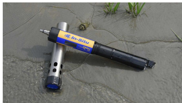
Figure 2: Sonde multi-paramètres AquaTroll 700 de la marque In-Situ.
